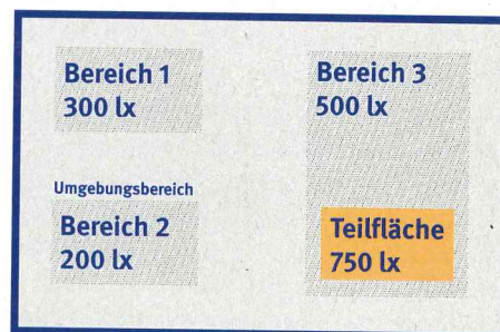
Abbildung 2 Arbeitsplatz- und teilflächen- bezogene Beleuchtung
